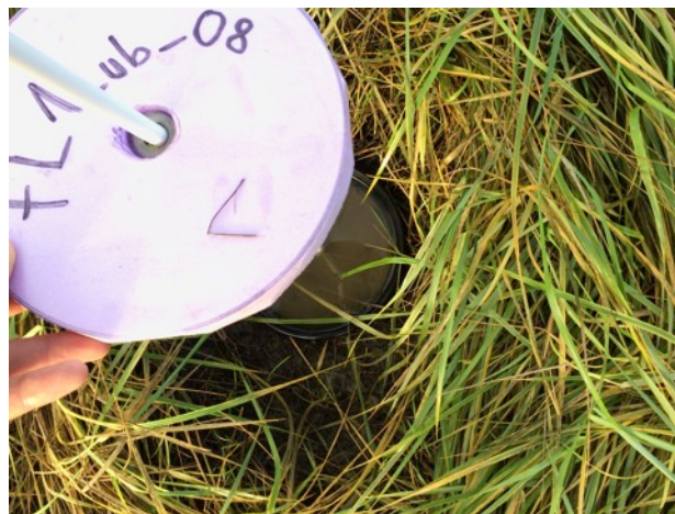
Abbildung 7: Sedimentfalle mit aufgefangenem Sediment in einer Brachfläche
